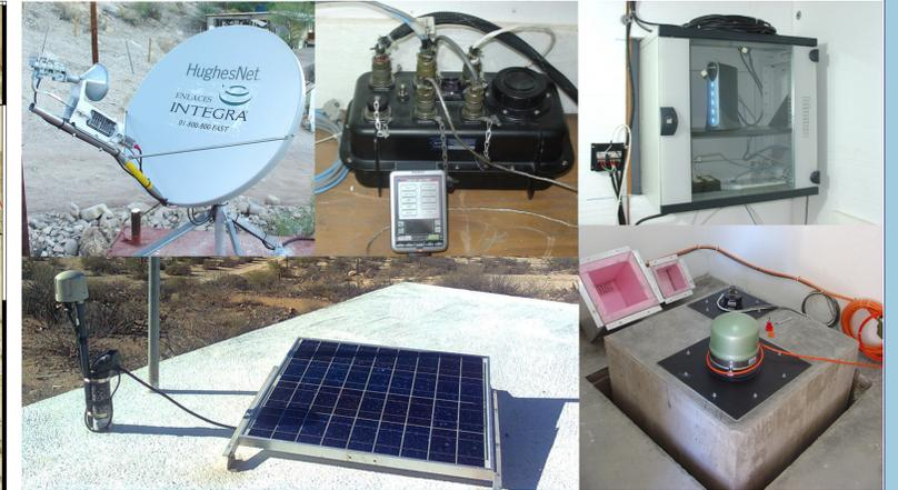
Elementos principales que integran una estación sismológica de la red RESBAN; antena para enlace satelital, baterías, enrutador, antena GPS, paneles solares, digitalizador, sismómetro y acelerómetro.
